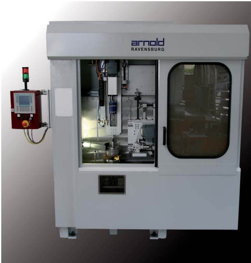
1 Bürstkopf horizontal: Verstellschlitten für verschiedene Bauteilgrößen 2 Zweiter Bürstkopf horizontal: Optional
