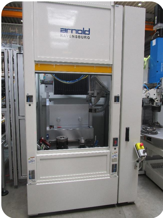
Abbildung: Anlage zum Reinigen von rotationssymmetrischen Bauteilen mittels Laser. Hier zu sehen ist eine Anlage für die Firma Daimler (DE).
